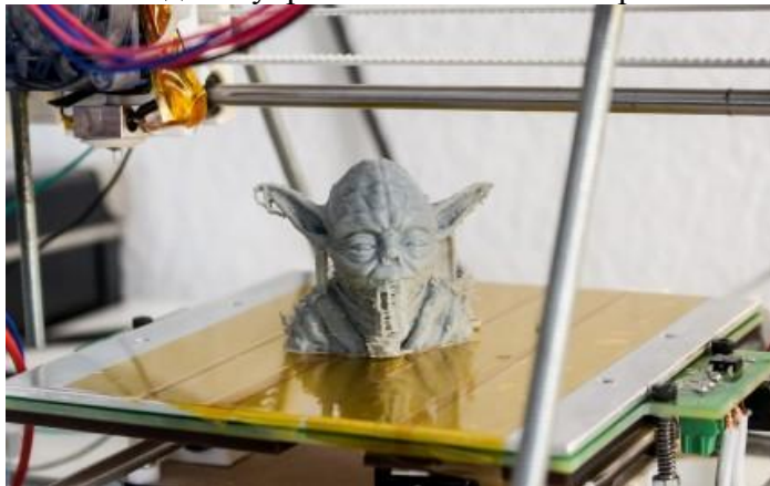
Рис.3 Распечатанная и необработанная модель
